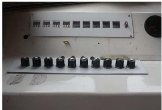
Gambar 10. Sistem kontrol SB1, SB2 dan SB3 Setelah proses modifikasi di ruang kemudi.
