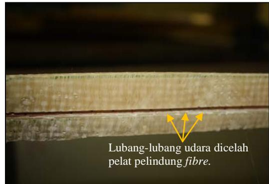
Gambar 5. Konstruksi lubang udara (pipa melintang).
