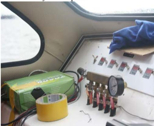
Gambar 8. Sistem kontrol tekanan udara dari SB1 di ruang kemudi (sebelum dimodifikasi).
